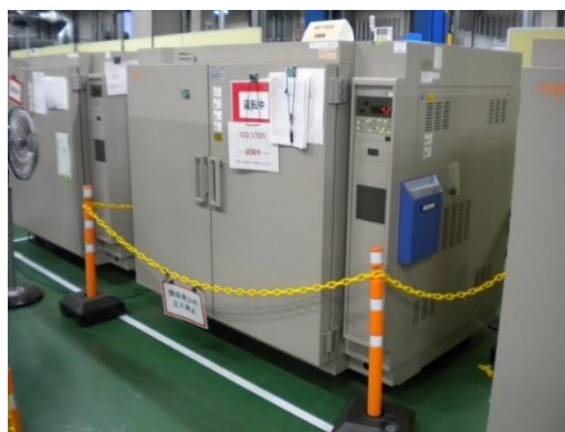
加速劣化試験に用いる恒温器試験設備
