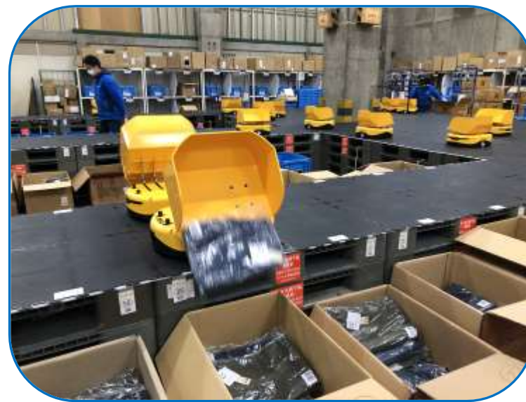
貨物の納品先毎に仕分け作業を行う次世代型ロボットソーター
