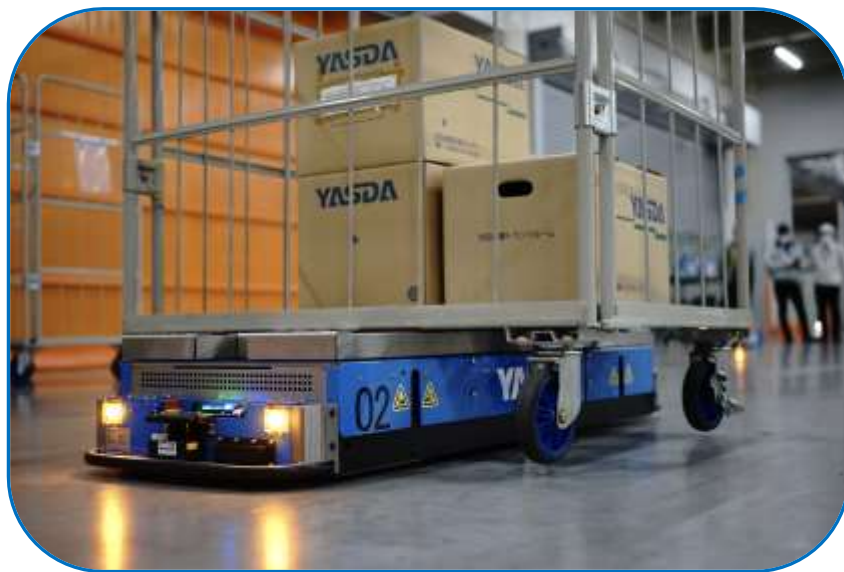
重量貨物を積載したカゴ台車を搬送する AGV（自動搬送車）
