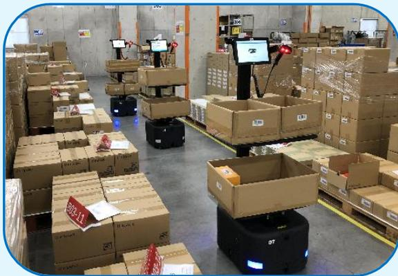
作業者と協働して貨物のピックアップを行うAMR（自律走行搬送ロボット）の導入
