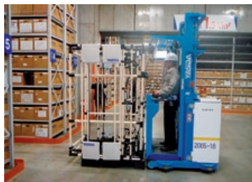
〈RFIDを利用した文書箱棚卸装置〉
