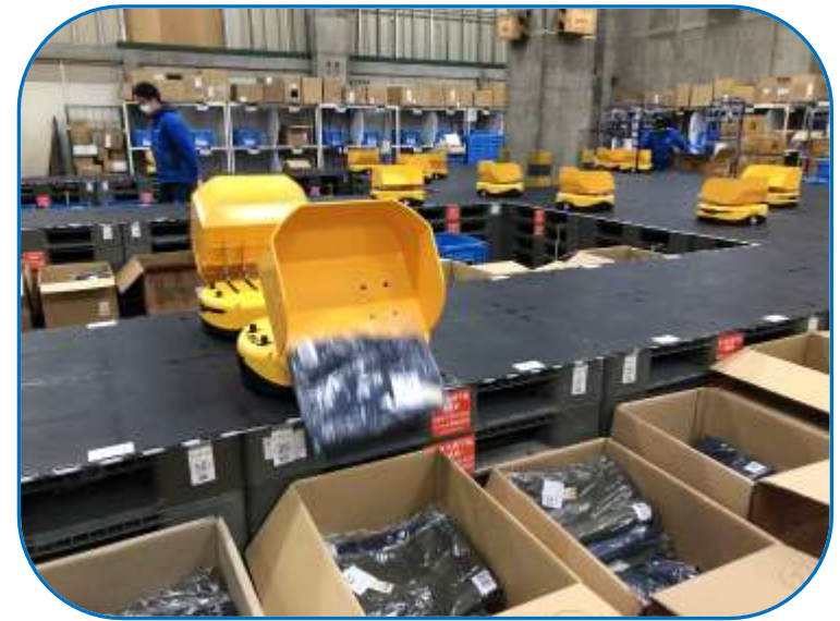
貨物の納品先毎に仕分け作業を行う次世代型ロボットソーター
