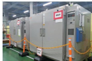
加速劣化試験に用いる恒温器試験設備
