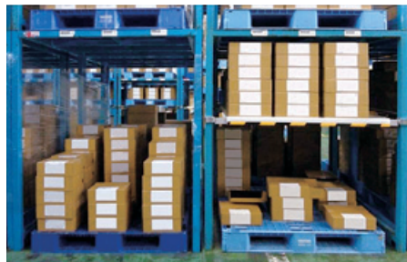
写真右側：中間棚を装着した棚式パレット
