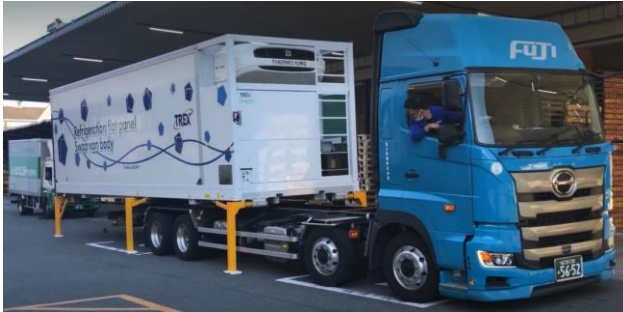
▲中央倉庫 京都PDセンターでのコンテナ脱着作業
